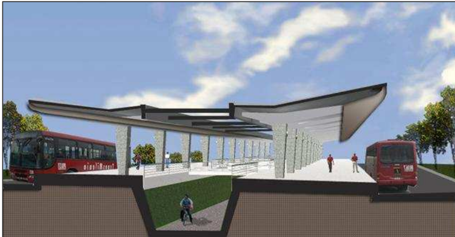
Imagen 17. Estaciones con paso deprimido de ciclorruta
